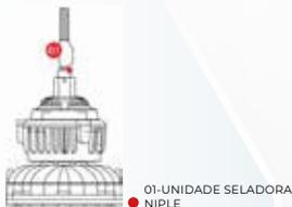
Na extremidade da luminária, utilize a unidade seladora para garantir o isolamento dos componentes.
