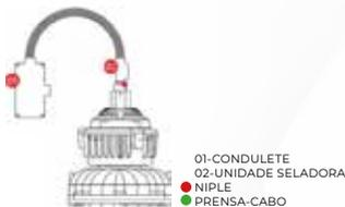
Na extremidade da luminária, utilize a unidade seladora. Não se esqueça de fazer a selagem após a instalação.
