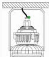
Utilize prensa-cabo na extremidade da luminária para garantir o isolamento dos componentes.
