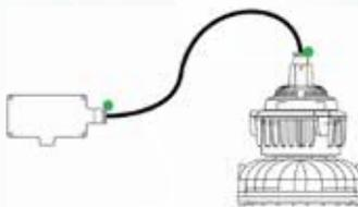
Utilize prensa-cabo nas duas extremidades do cabo para garantir o isolamento dos componentes.
