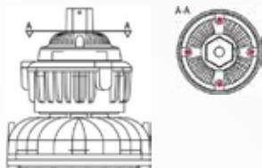
Retire os 4 parafusos na parte superior para ter acesso ao borne de ligação dos fios.
